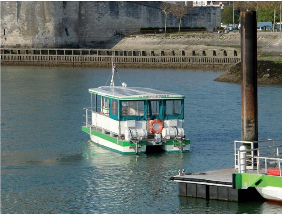
PHOTO 22 ■ **Passeur électro-photovoltaïque de La Rochelle (France).**
