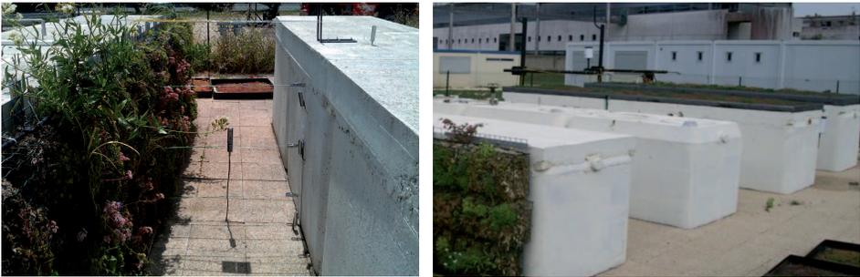
**Figure 2.6.** Maquette d'une rue canyon avec façade végétale à échelle 1:10 (université de La Rochelle). Photos : E. Bozonnet.
