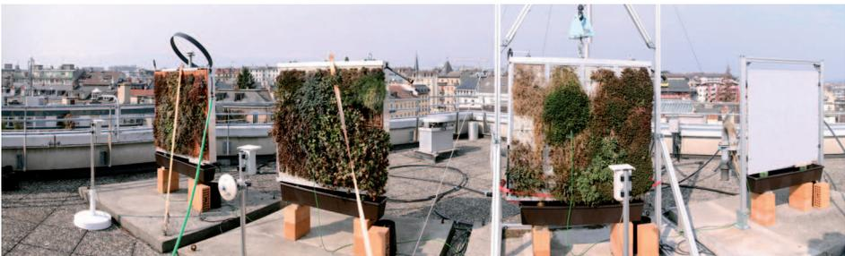
**Figure 3.2.** Éléments de façade expérimentés sur le toit de l'Hepia (Genève). Source : Malys *et al.* (2014), avec la permission d'Elsevier.
