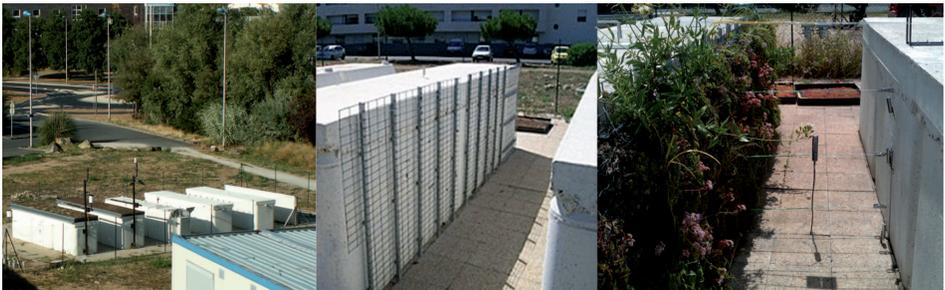
**Figure 2.2.** Plateforme Climatbat (université de La Rochelle) reproduisant des rues canyon à échelle 1:10. Photos : E. Bozonnet.
